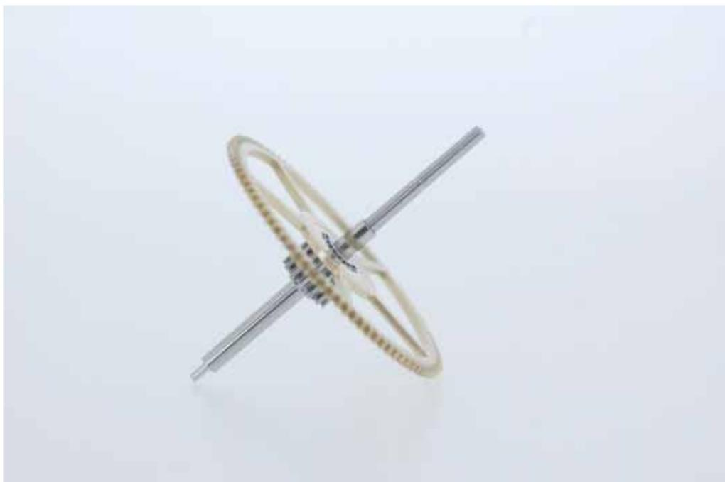
Continués la restauración puliendo el pivote de la rueda de centro, el cual estaba muy deteriorado, y fabriqué un nuevo cojinete con la misma forma que el puente.
